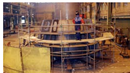
De färdiga bojarna är sju meter höga. Här pågår montage av bojens övre del.
